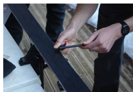
Réparation de la semelle
